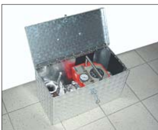
Bild 2 - 4: Messung des statischen und dynamischen Druckes sowie des Volumenstromes
