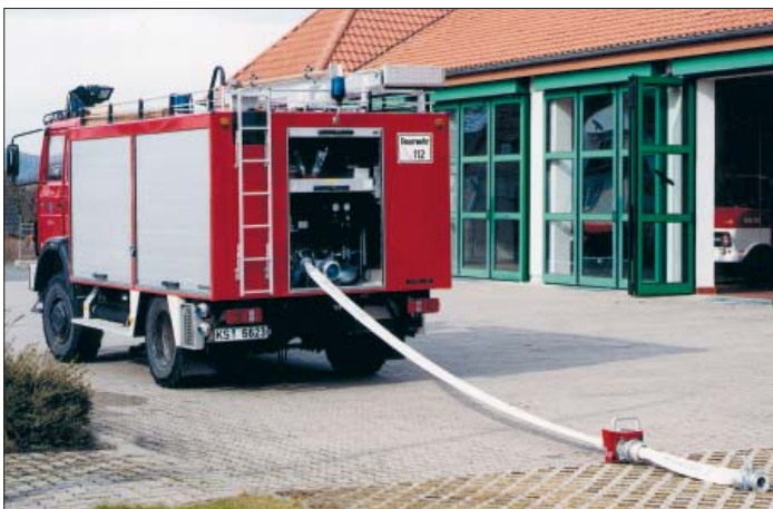
Bild 2 - 4: Messung des statischen und dynamischen Druckes sowie des Volumenstromes
